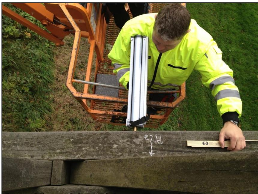
**Bild 2:** Bohrwiderstandsuntersuchung eines Fachwerkgurtes
