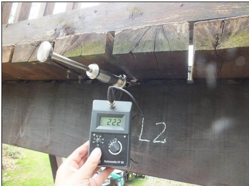
**Bild 1:** Holzfeuchtemessung mit einem elektrischen Widerstandsgerät
