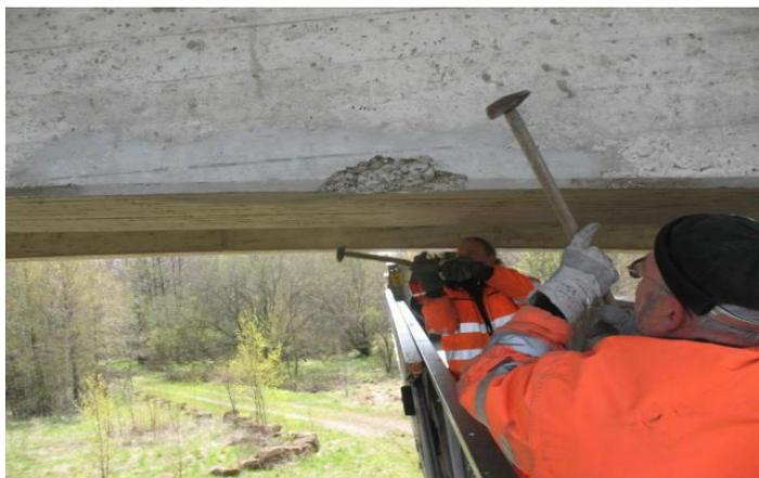
Der „Prüfhammer“ ist ein einfaches, probates Gerät, um durch „Abklopfen“ Fehlstellen im Beton aufzuspüren.
