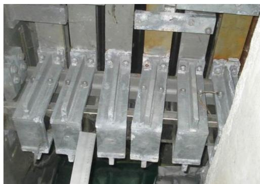
Bild 10. Steuerung ungleichmäßig Traversen bereits verbogen
